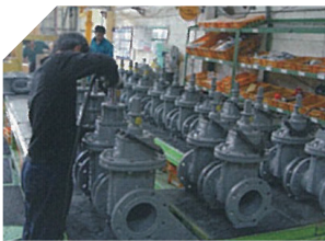
▶ 제품조립(Product Assembly) 가공, 도장공정을 거친 부품의 최종 조립
