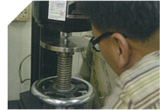
▶ 원재료 검사(Material Mechanical Testing) 입고시 원재료의 샘플을 채취하여 기계적성질 검사
