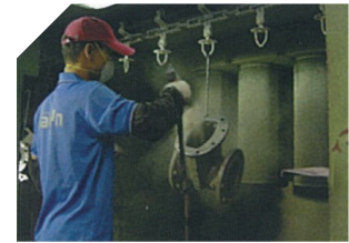
▶ 에폭시 분체도장(Epoxy Coating) 에폭시 분체도장을 사용하여 내식성, 내마모성이 매우 우수
