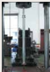
대한 버티미 30TON 압축정하중 시험
