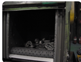
도장 전처리(Blast Cleaning)
